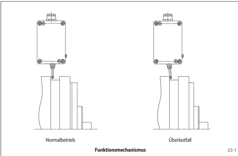
Bei SIKUMAT®-Drehmomentbegrenzern kann die Axialbewegung beim Überlastvorgang zur Betätigung eines Grenztasters genutzt werden. Dadurch kann beim Überschreiten des eingestellten Grenzdrehmoments der Antrieb elektrisch abgeschaltet und/oder ein Signal ausgelöst werden.
