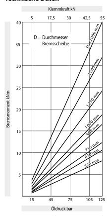
Öldruck: min. 15 bar max. 125 bar
