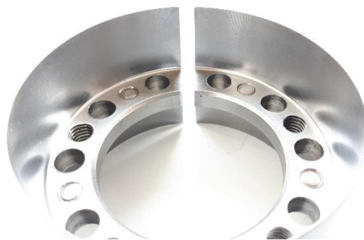
Bild 9: Spannsatz RLK402 nach Wellenbruch
